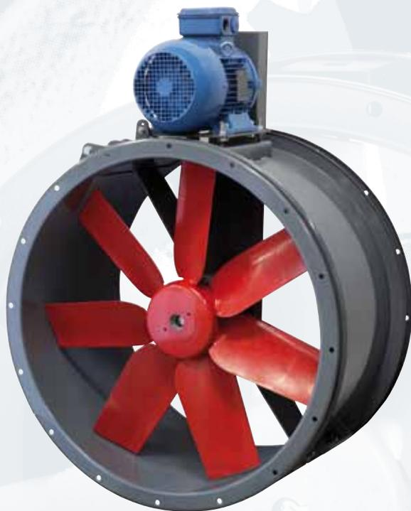
Осевые вентиляторы в цилиндрическом корпусе серии ТТТ-N предназначены для продолжительной работы при температуре перемещаемого воздуха до 120°C. Электродвигатель находится вне потока перемещаемого воздуха и связан с крыльчаткой при помощи ременной передачи.
